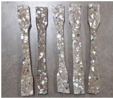
Fig. 7 Probetas elaboradas para la prueba de tracción
