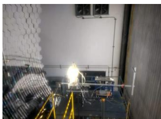
Figura 2. Fotografía del concentrador, reactor solar y atenuador.
