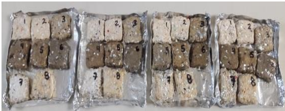
Fig. 6. Probetas elaboradas para prueba de Intemperismo Acelerado
