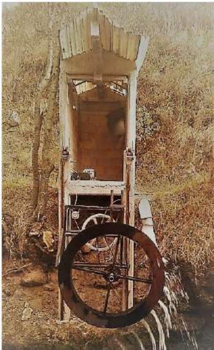
Figura 6. Sistema micro hidroeléctrico en operación.
