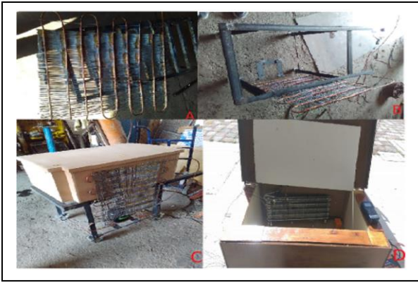
Fig. 1. Construcción del Sistema de refrigeración.
