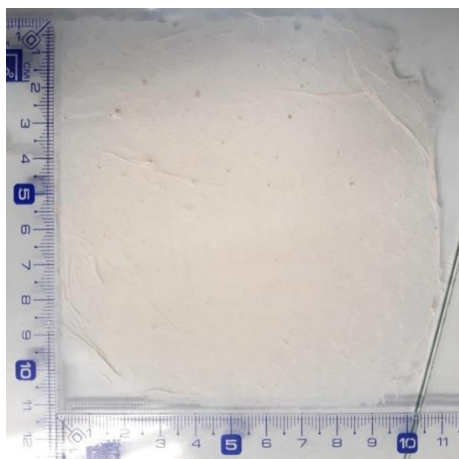
Fig. 2. Membrana de intercambio catiónico con aditivo SDS. Relación PVC:SDS=1.5:0.4 (m/m)
