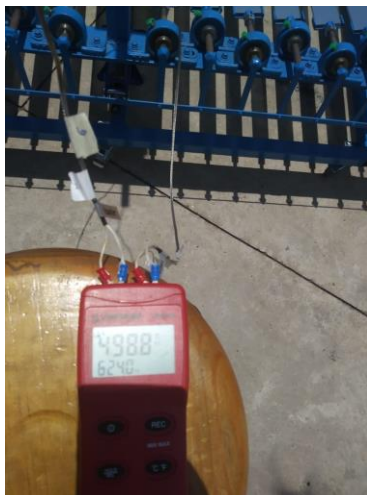
Fig 4. Medición de la temperatura en el colector
