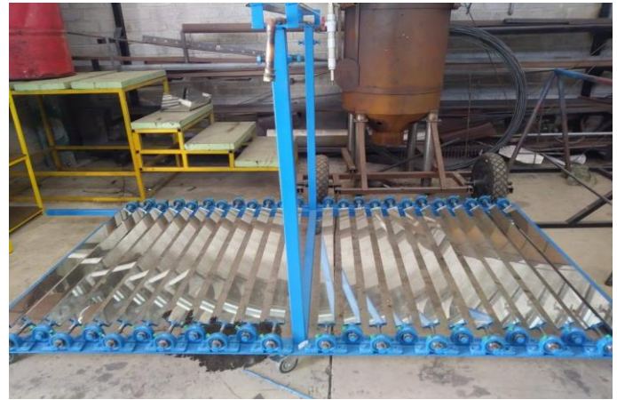
Fig 2. Colector Fresnel lineal construido en el taller
