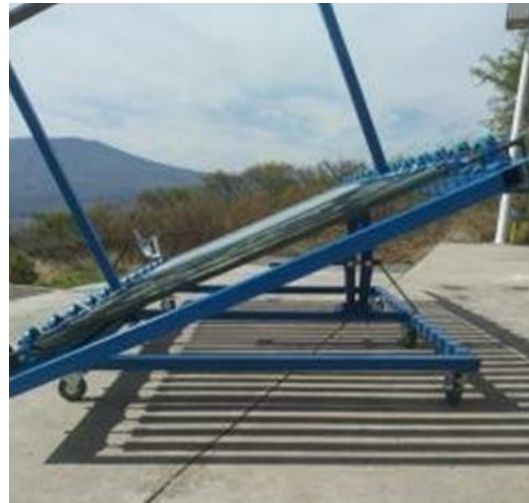
Fig 3. Prueba de funcionamiento del colector solar
