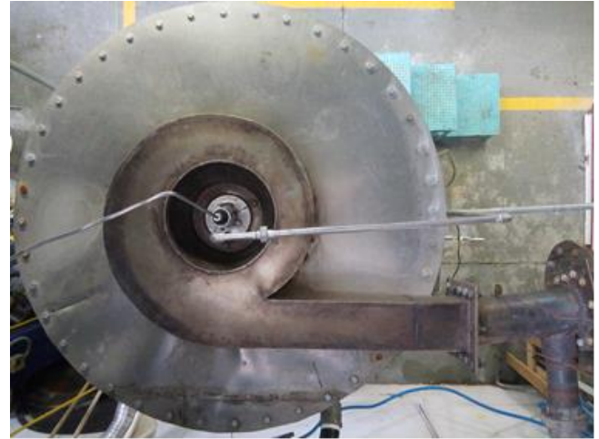
Figura 6. Colocación del dispersor de gas sobre la tapa el secador por aspersión de escala-piloto
