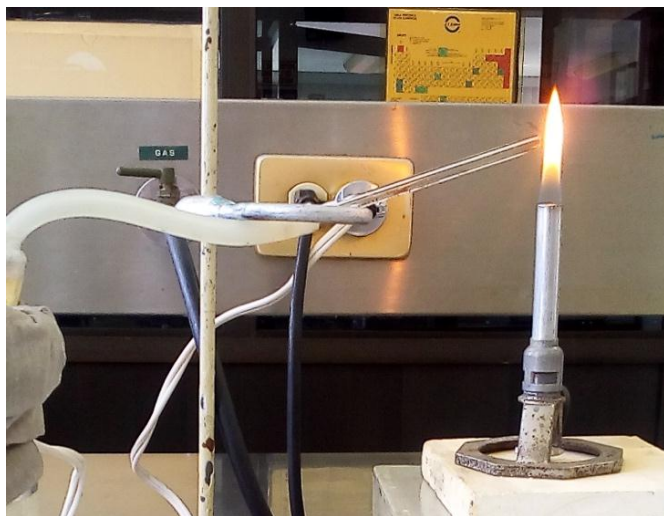
Fig. 10. Emisión de flama lograda con el sistema de fotocatalítico empleando \text{LaZnO}
